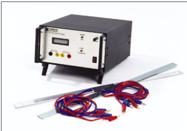
MT 3004-E Venymäliuskasilta
