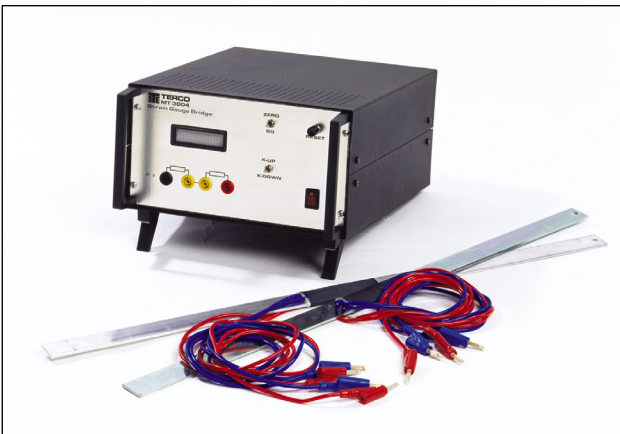
MT 3004-E Venymäliuskasilta
