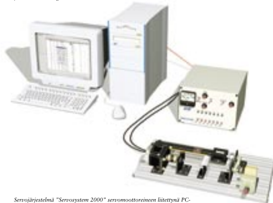
Servojärjestelmä "Servosystem 2000" servomoottoreineen liitettyä PC-tulvointaiseen Servopack-laitteeseen.
