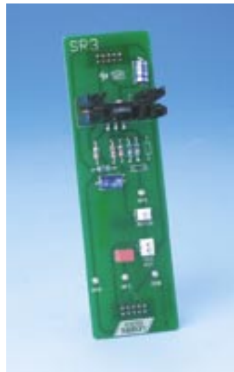
T1620009 Asentomodula SR3 Asentomodula kiinnitetään servosäädinkorttiin SR1.
