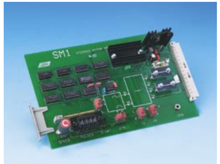
T1620012 Askelmoottorimoduuli SM1 Askelmoottorimoduuli SM1 kiinnitetään perusyksikköön ja sillä ohjataan askelmoottoria.
