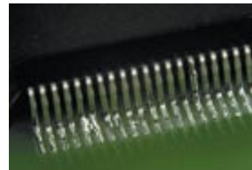
8.18 PFPCC-piirin näin tiheässä olevien jalkojen välillä syntyy helposti mullitusta.
