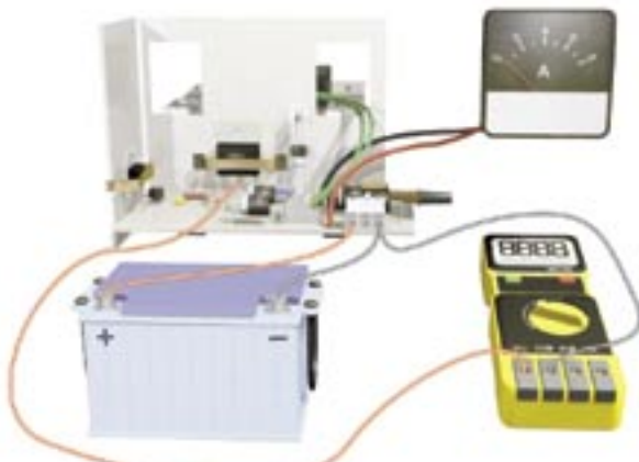
7.01 Jännite virta akun transistorin Q 1 kollektorin ja emitterin välillä.
