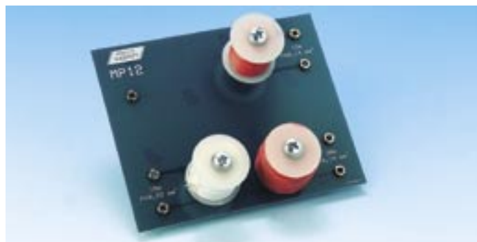
T11010013 Harjoituslevy MP12 - Johtimen resistanssi Rullalla olevan langan resistanssin määrittäminen.
